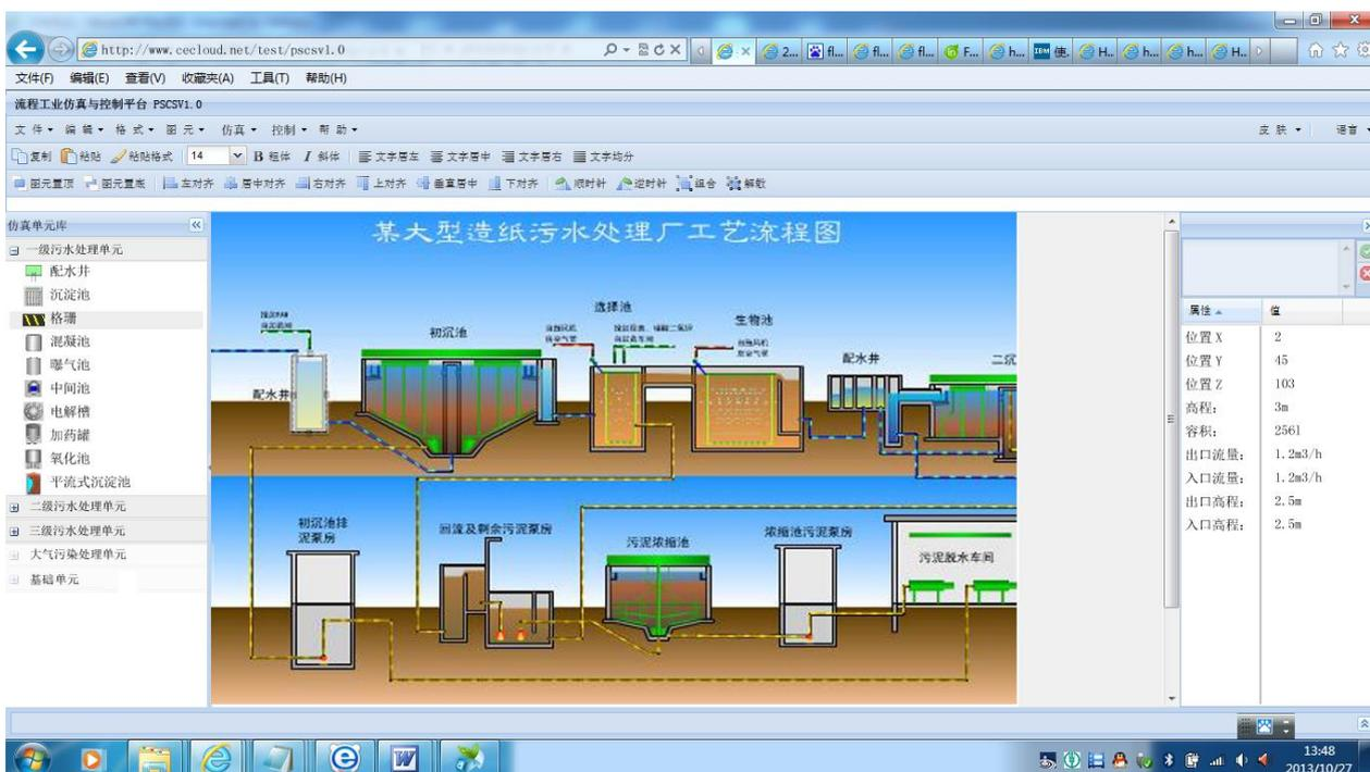
依据各个单元按照运行规范，设计工艺参数，连接控制器，编写控制程序，组态监控程序，然后开展虚拟运行调试，虚拟操作各处理设备、进行进出水监测，通过进行水污染控制设计和运行系统操作实践，全面和快速的提升专业技能，系统还会对运行操作的过程和结果进行考核和评比。
